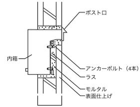
ポスト口（560系）と内掛（570）の組合せでご使用下さい。ポスト口は開口350ワイド設計で、角2封筒サイズも楽々投函でき内掛は単板構造です。
